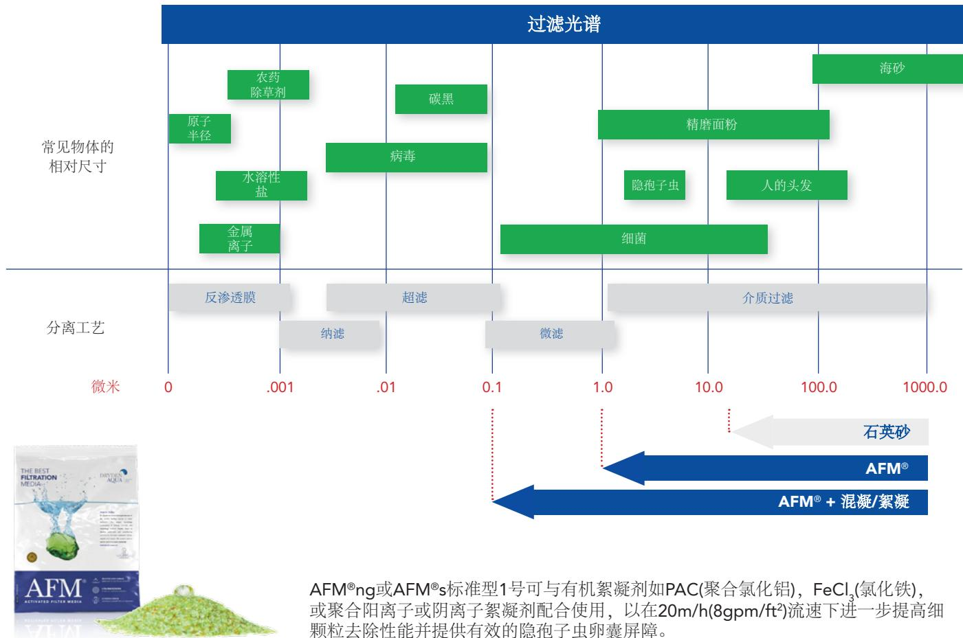
AFM®ng或AFM®s标准型1号可与有机絮凝剂如PAC(聚合氯化铝), FeCl<sub>3</sub>(氯化铁), 或聚合阳离子或阴离子絮凝剂配合使用, 以在20m/h(8gpm/ft<sup>2</sup>)流速下进一步提高细颗粒去除性能并提供有效的隐孢子虫卵囊屏障。
